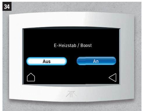
**INFO** Ihr System verfügt je nach Ausstattung über einen E-Heizstab bzw. eine Boost Funktion. Durch Aktivieren der Funktion E-Heizstab / Boost verkürzt sich die Aufwärmphase des Wassers.
