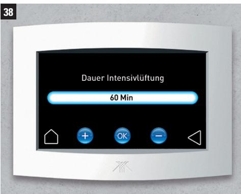
**INFO** Während der Dauer der Intensivlüftung ist in den Betriebsarten Winter / Sommer keine Auswahl der Lüftungsstufen möglich.
