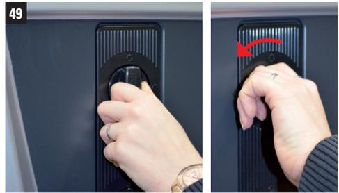
Die Abdeckkappen in der Front des Gerätes lassen sich durch eine viertel Drehung nach links lösen und herausziehen.
